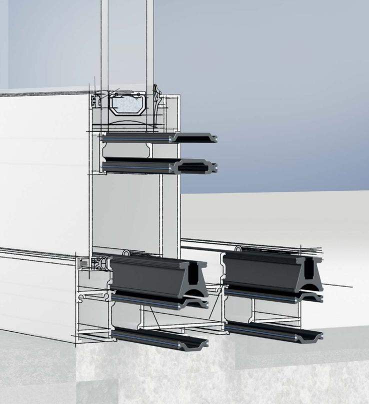
*Nos profilés spéciaux offrent une large gamme de solutions pour portes, fenêtres, systèmes coulissants et façades. Ils séduisent par une isolation thermique optimale, des propriétés de profilés adaptées à l'application, un usinage efficace et une précision maximale.*
