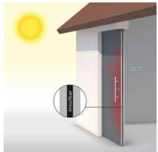
Gracias a la actuación del perfil shear-free de insulbar, las dilataciones longitudinales diferentes del perfil interior y exterior se compensan eficazmente.
